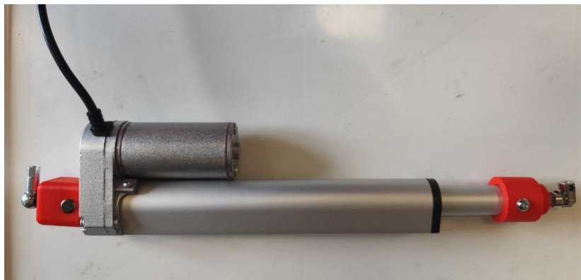
3 сурет – сызықтық электрлік жетегінің екі ұшына қосымша компоненттер
